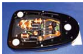
ISO (Isolated) マウントネット Zワークフィルタ部
